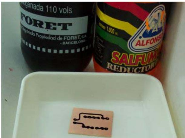
o.- Se sitúa el ácido sobre una cubeta de plástico (¡jojo! nunca metálica) y se introduce la placa. Dejar actuar a la mezcla dando un ligero movimiento a la cubeta observando la placa. En ocasiones la reacción es muy rápida, y se producen muchos vapores en este caso retirar la placa para evitar que se pierdan las pistas y se malogre. Para manipular la placa utilizar pinzas de plástico, las pinzas metálicas se verían afectadas por el ácido y se destruirían.
