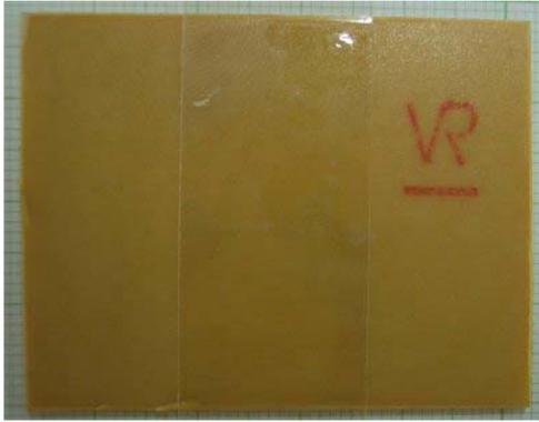
j.- Damos la vuelta a la placa y el papel juntos. Con ayuda de un punzón, se marcan con suavidad los centros de los agujeros por la cara de pistas (cobre). Prestar especial atención a no profundizar con el punzón sobre el soporte aislante o se quebrará. Para esta tarea utilizar la mano y nunca el martillo.
