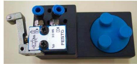
1.3 Válvula 3/2, NC, Final de carrera. Accionamiento por rodillo, retorno por muelle.
