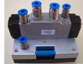
1.2 y 1.4 Válvulas 3/2, NC. Accionamiento por pulsador, retorno por muelle.
