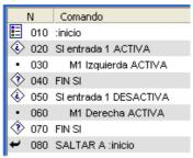
**12.-** Disponemos de un motor (M1) conectado entre los terminales S8 y S7. Deseamos que el motor se ponga en marcha si el interruptor l1 está activado (nivel alto). El sentido de giro será a derechas si l2 esta activado (nivel alto) y a izquierdas si l2 está desactivado (nivel bajo). Implementa el programa que lo resuelve, y dibuja su organigrama. Observa que el programa HobbyRobot, no permite anidar bucles Si-fin si.
